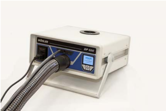
Afb. 17: Aansluitingen op het meetapparaat voor dichtheidsmeting, type N: voedingskabel, drukaansluitslang en kunststofslang
