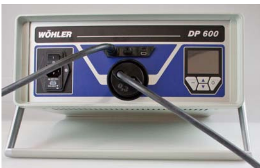
Afb. 12: Aansluiting van druk- en luchtslang op de Wöhler DP 600
